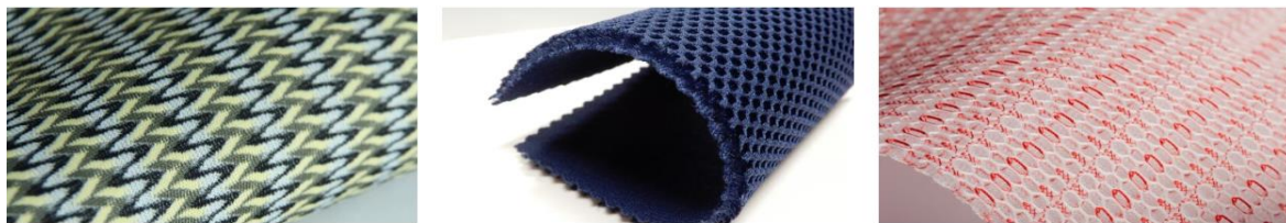
Gambar 5. Kain Yang Biasa Di Produksi Di Mesin Raschel Double Needle (Karl Mayer, n.d.)
