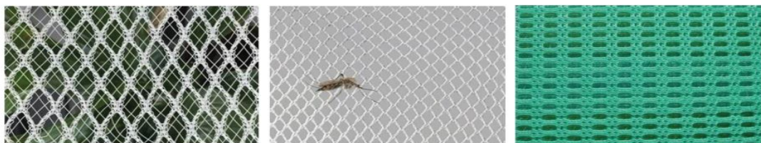
Gambar 3. Contoh Kain Mesh Yang Dibuat Di Mesin Tricot Single Needle (Cassidy & Goswami, 2018)
