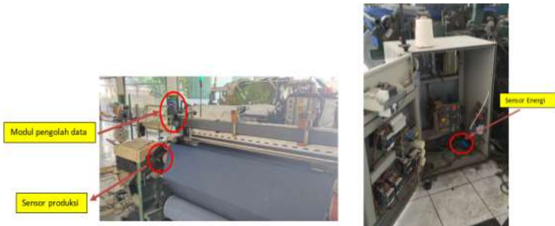
Gambar 12. Proses pemasangan modul pemantau pada mesin AJL (Sumber: dokumentasi pribadi).
