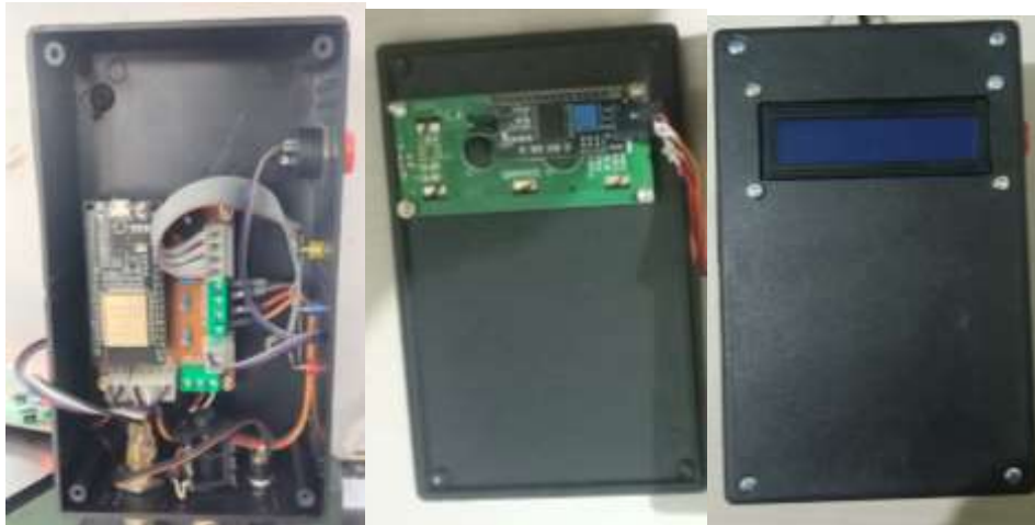
Gambar 8. Modul pemantau yang sudah dilakukan perakitan
